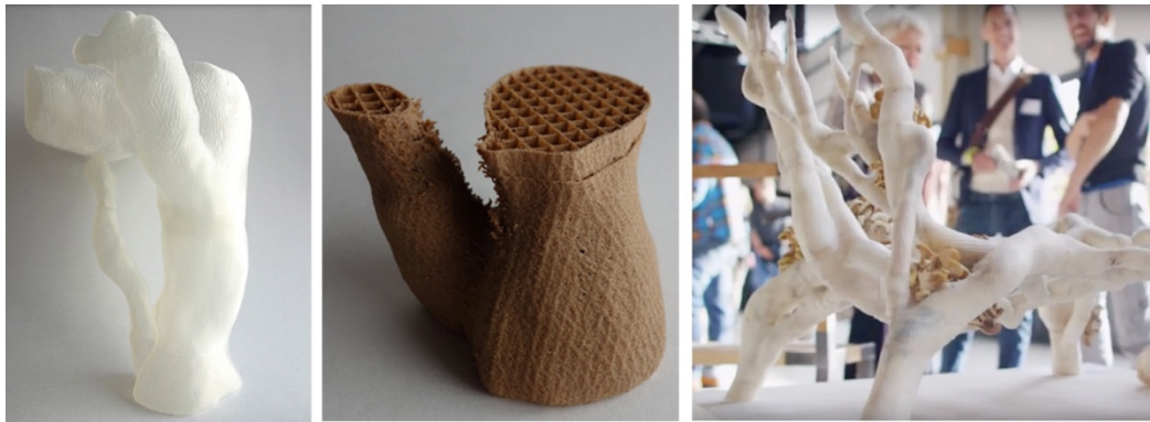
Şekil 4.14 : Miselyum Sandalyesi'nin üretim sürecine bakış, soldaki 3D yazıcı ile üretilmiş PLA, ortadaki saman karışımı ve sağda sandalyenin kendisi (Url-29).
